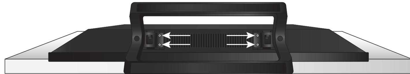
3. Con un destornillador Phillips, ajuste cuatro (4) tornillos T4 de en la base para asegurarla al televisor.
