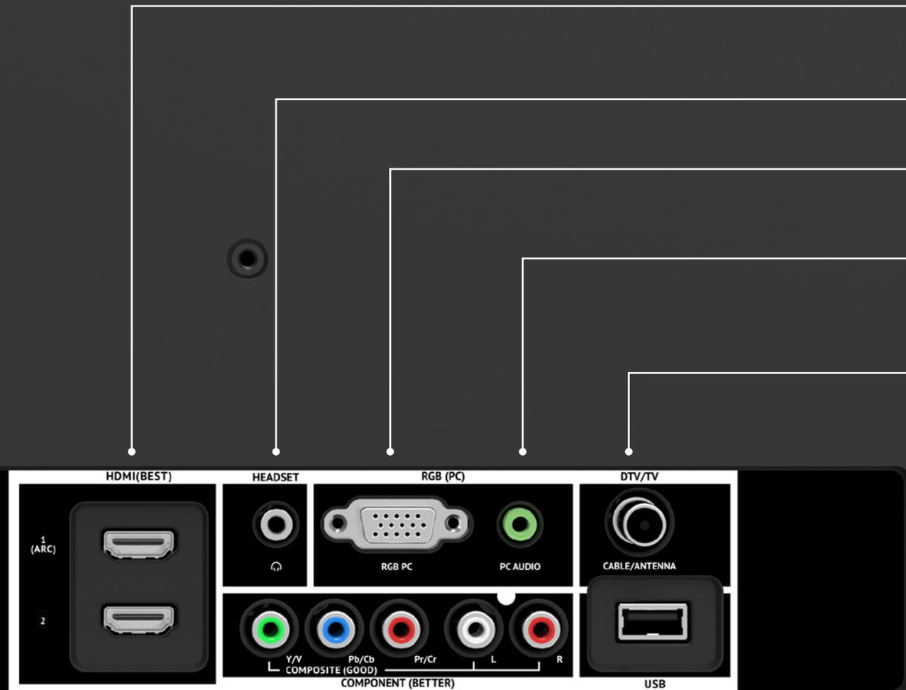
**HDMI:** Permite conectar un dispositivo HDMI.
