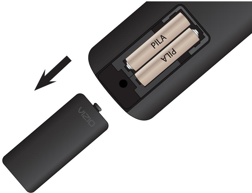
1. Retire la cubierta del compartimiento de las baterías.
