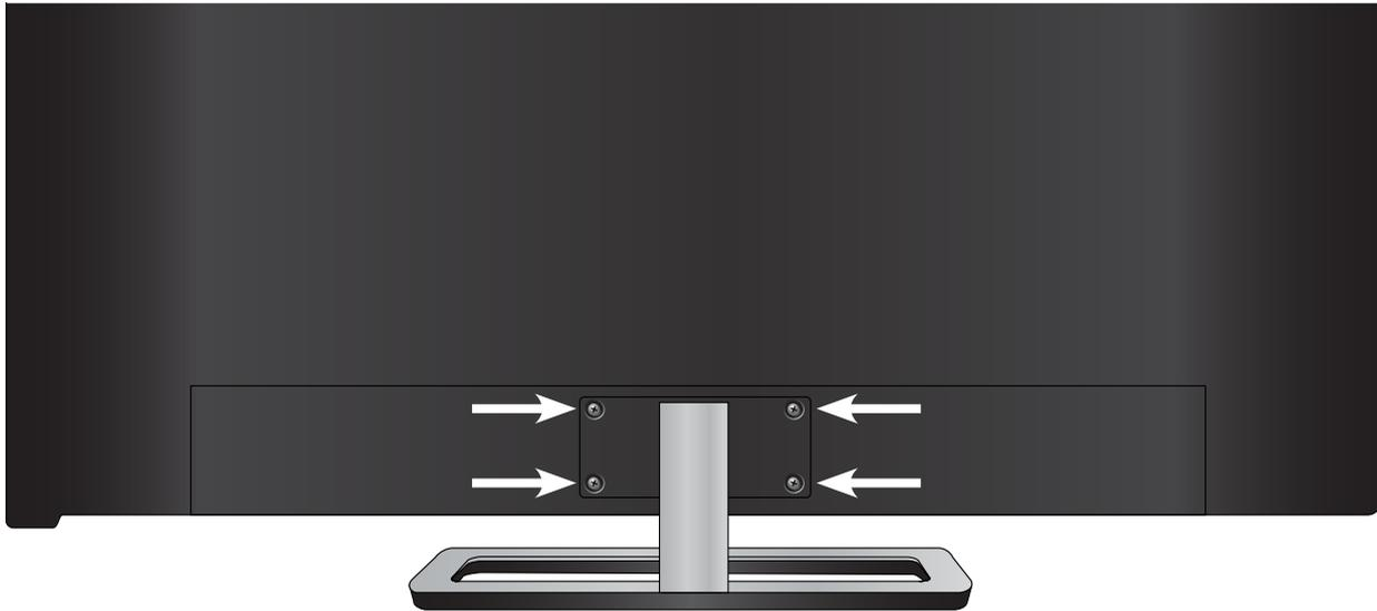
**M492i-B2 et M552i-B2 :** Alignez la base avec le derrière du téléviseur. Insérez et serrez à l'aide d'un tournevis cruciforme les quatre (4) vis cruciformes M6 18mm incluses dans les trous à l'arrière du téléviseur.
