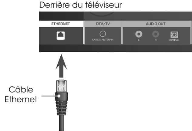
Si vous possédez une connexion Internet haute vitesse, branchez un câble Ethernet de votre modem ou routeur au derrière de votre téléviseur tel qu'illustré. Pour la meilleure expérience du téléviseur intelligent, VIZIO recommande d'utiliser un câble Ethernet. Par contre, votre téléviseur est également doté d'une connectivité Wi-Fi intégrée. Consultez la section *Se connecter à l'Internet par une connexion Wi-Fi* pour obtenir des renseignements supplémentaires.
