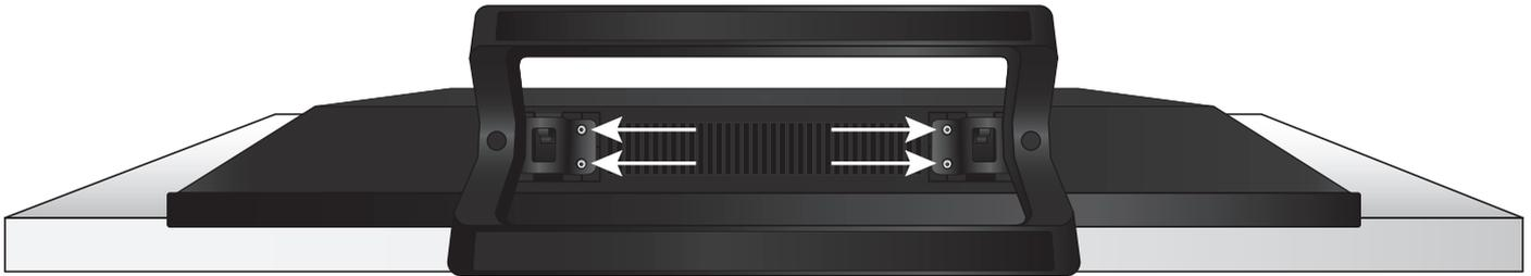
À l'aide d'un tournevis cruciforme, serrez quatre (4) vis T4 10mm dans la base afin de la fixer solidement au téléviseur.
