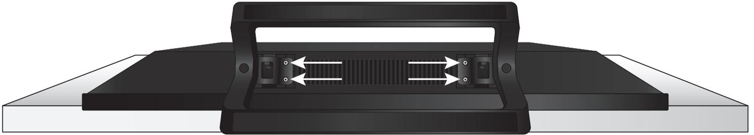
Con un destornillador Phillips, ajuste cuatro (4) tornillos T4 de 10 mm en la base para asegurarla al televisor.
