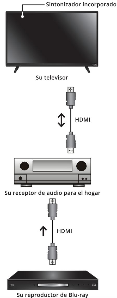
Con una configuración de HDMI ARC, la conexión de audio entre su televisor y su receptor de audio para el hogar puede eliminarse. El cable HDMI transmitirá señales de audio desde y hacia su televisor con una conexión de audio/video totalmente digital.
