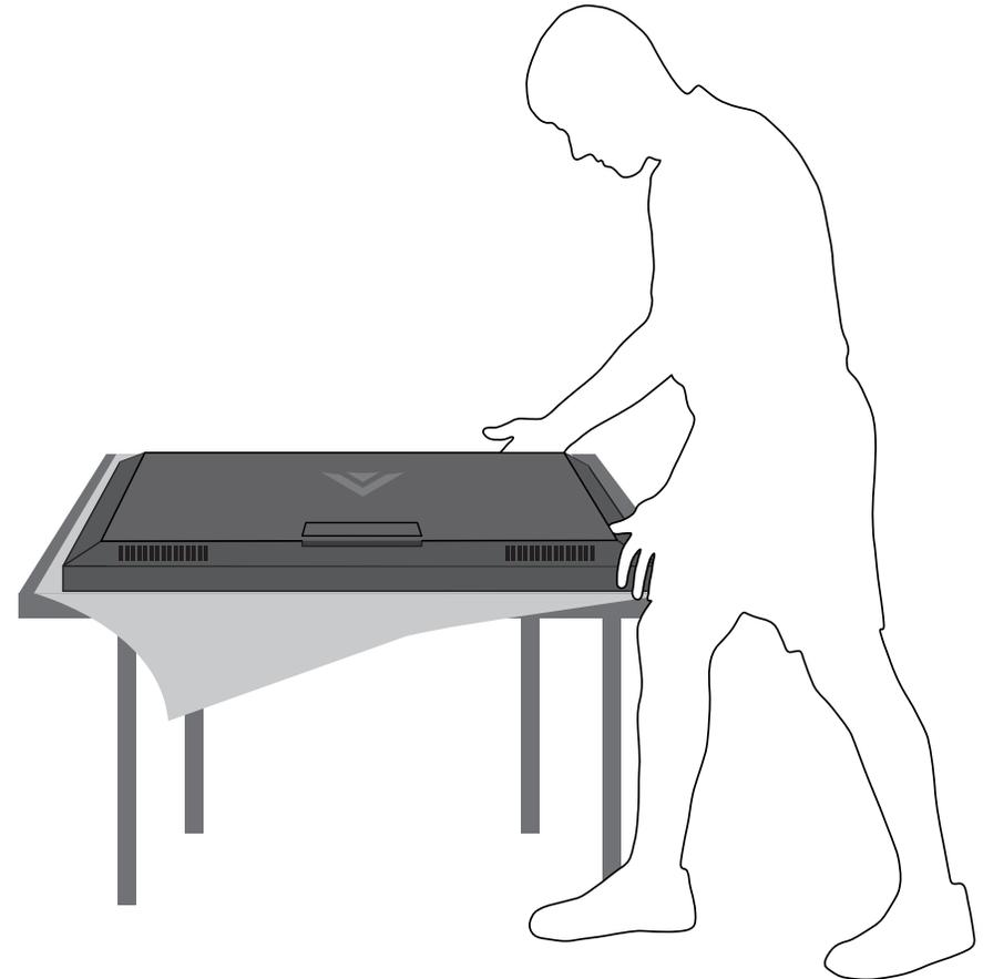
Coloque la pantalla del TV hacia abajo sobre una superficie limpia y plana. Para prevenir ralladuras o daños en la pantalla, coloque el TV sobre una superficie suave, como una manta, y evite bordes puntiagudos.
