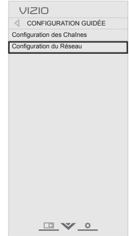
Appuyez sur le bouton **MENU** pour afficher le menu **RÉGLAGES DE LA TV**. Utilisez les **flèches** pour mettre en surbrillance **Configuration Guidée** et appuyez sur **OK**.
