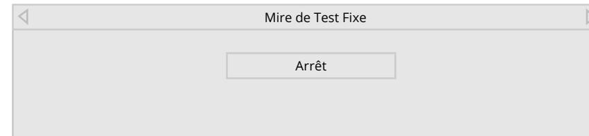
2. Appuyez sur les **flèches** de la télécommande pour mettre en surbrillance **Arrêt**. Utilisez les **flèches gauche/droite** pour sélectionner le pourcentage de luminosité pour la Mire de Test Fixe. La sélection du pourcentage affiche immédiatement la Mire Fixe à cette luminosité.
