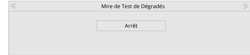
2. Appuyez sur les **flèches** de la télécommande pour mettre en surbrillance **Arrêt**. Utilisez les boutons de **flèche gauche/droite** afin de choisir la couleur pour la Mire de Test de Dégradés. La sélection de la couleur affiche immédiatement cette rampe de couleur.
