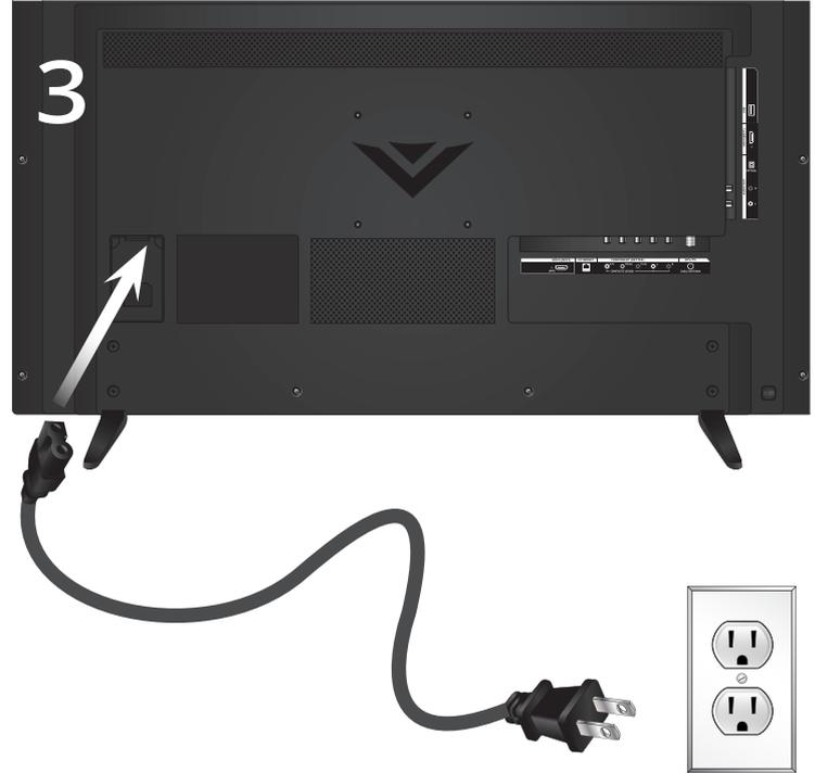
Branchez le cordon d'alimentation à l'arrière du téléviseur. Le bord plat du connecteur doit faire face au bas du téléviseur.
