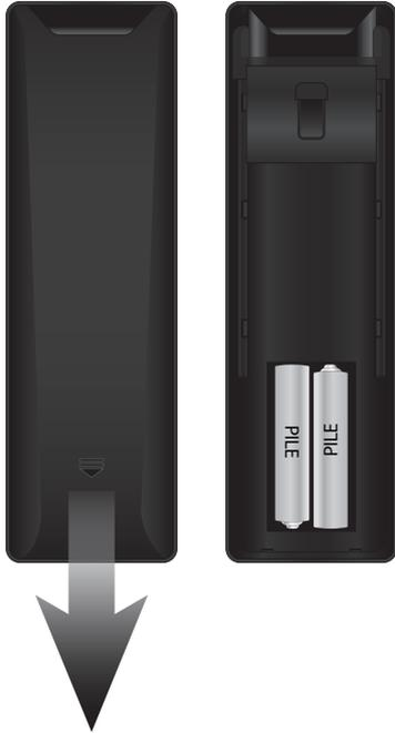
Retirez le couvercle de la batterie en appuyant doucement sur le logo et glissez sur la télécommande.
