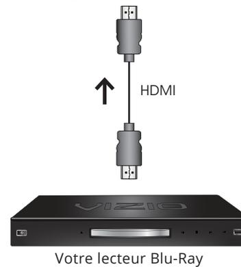
Lors d'une installation HDMI ARC, la connexion audio entre votre téléviseur et votre syntoniseur audio maison peut être enlevée. Le câble HDMI transmettra le signal audio entre le téléviseur et les autres appareils par une connexion audio-vidéo entièrement numérique.
