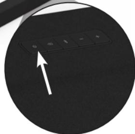
Primero confirme que el interruptor de encendido está en la posición **ON** (Encendido). **Mantenga presionado** el botón Pairing (Emparejar) en la parte posterior del bafle por 5 segundos. El LED en la parte posterior del bafle comenzará a parpadear.
