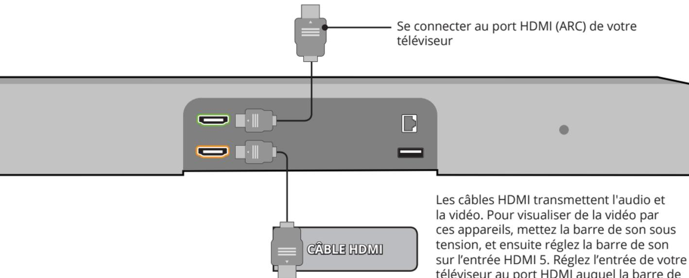
Les câbles HDMI transmettent l'audio et la vidéo. Pour visualiser de la vidéo par ces appareils, mettez la barre de son sous tension, et ensuite réglez la barre de son sur l'entrée HDMI 5. Réglez l'entrée de votre téléviseur au port HDMI auquel la barre de son est branchée.
