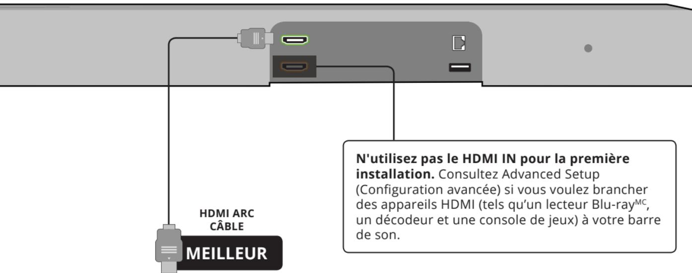
**N'utilisez pas le HDMI IN pour la première installation.** Consultez Advanced Setup (Configuration avancée) si vous voulez brancher des appareils HDMI (tels qu'un lecteur Blu-ray<sup>MC</sup>, un décodeur et une console de jeux) à votre barre de son.
