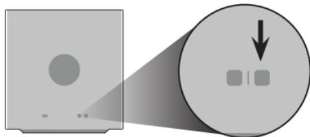
Confirmez d'abord que le voyant DEL Alimentation est allumé. **Appuyez pendant 5 secondes sur le** bouton Pairing (appariement) se trouvant à l'arrière du caisson de basses. Le voyant DEL situé à l'arrière du caisson de basses commencera à clignoter.
