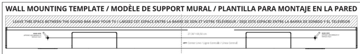
Placez le modèle de support mural fourni contre le mur, sous votre téléviseur. Marquez les deux trous des fixations à l'aide d'un crayon.
