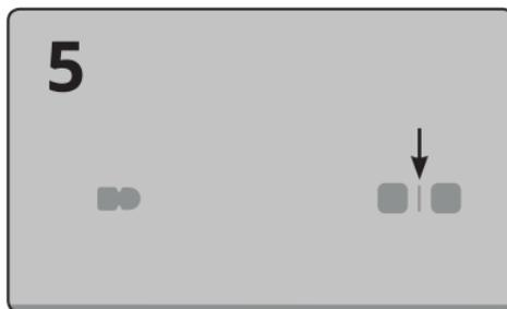
Enfoncez le bouton Alimentation pour mettre le caisson de basses sous tension. Le voyant DEL s'allumera. Le caisson de bas doit être allumé automatiquement lorsqu'il est branché.
