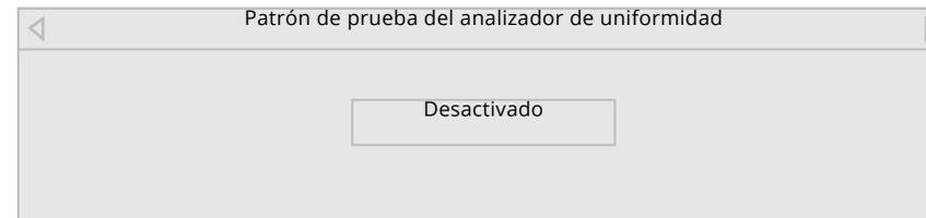
2. Use los botones de las **flechas** del control remoto para resaltar **Desactivado**. Use los botones de las **flechas izquierda y derecha** para resaltar **Activado** y mostrar el Patrón de prueba del analizador de uniformidad.
