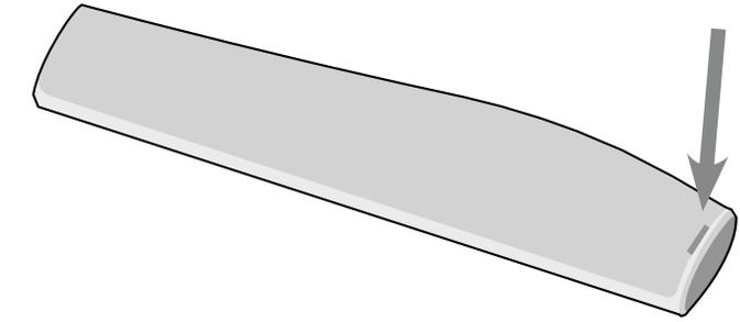
2. Coloque dos pilas en el control remoto. Asegúrese de que los símbolos (+) y (-) de las pilas coincidan con los símbolos (+) y (-) que se encuentran dentro del compartimiento.
