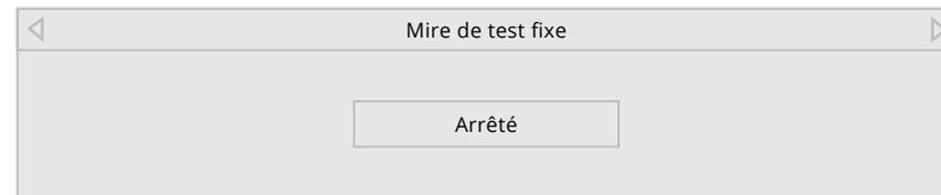
1. Appuyez sur les **flèches** de la télécommande pour mettre en surbrillance **Arrêté**. Utilisez les **flèches gauche/droite** pour sélectionner le pourcentage de luminosité pour la mire de test fixe. La sélection du pourcentage affiche immédiatement la mire fixe à cette luminosité.
